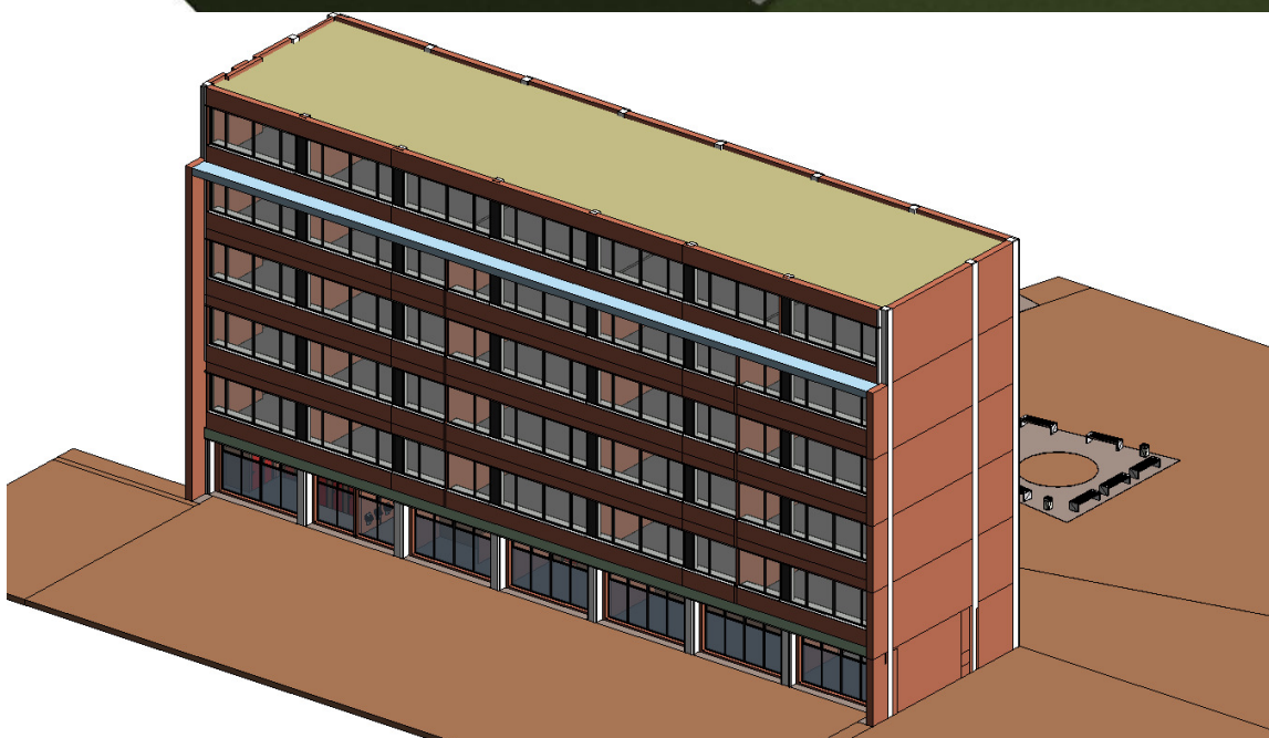
Obrázek 14 Přenos dat pomocí souboru IFC mezi SW ArchiCAD a Revit [autor]
