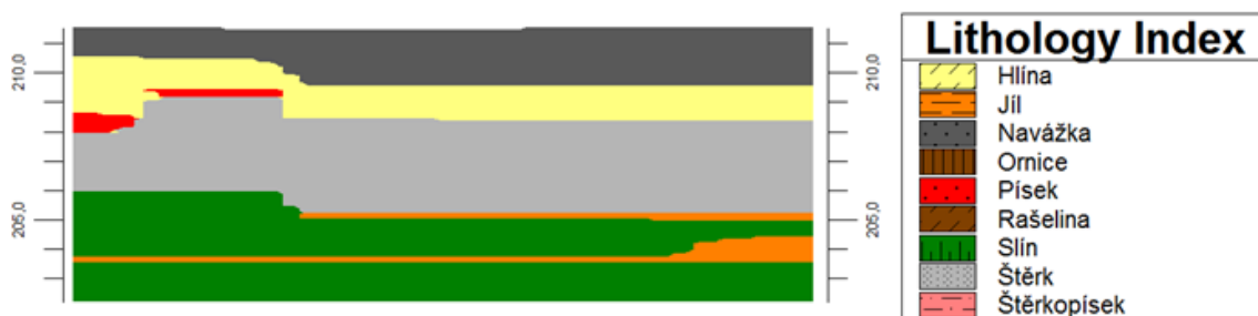
Obr. 13: Řez modelem v okolí sledovaného objektu
