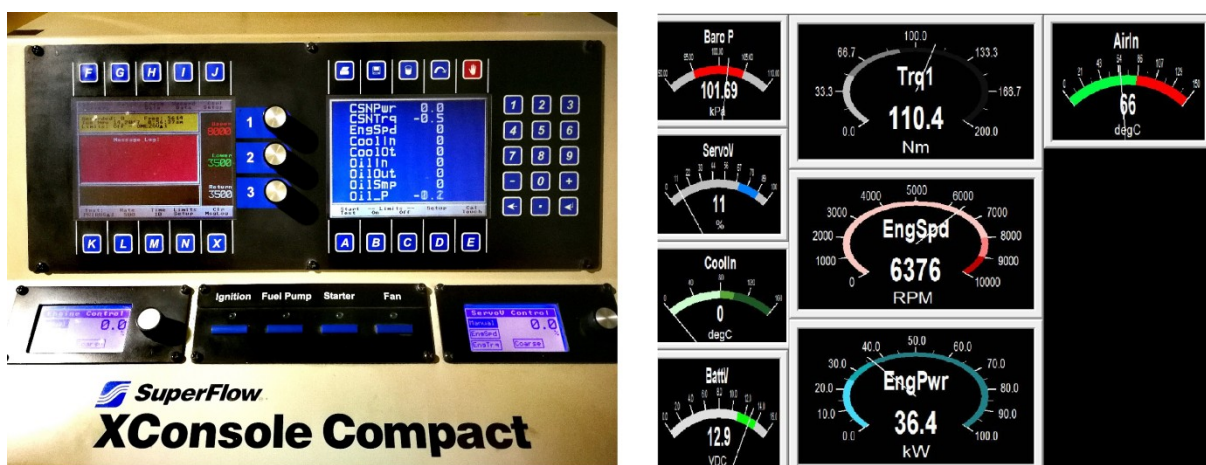
Obr. 38 Ovládací panel motorové brzdy Superflow (vlevo), Data v reálném čase v programu WinDyn (vpravo).
