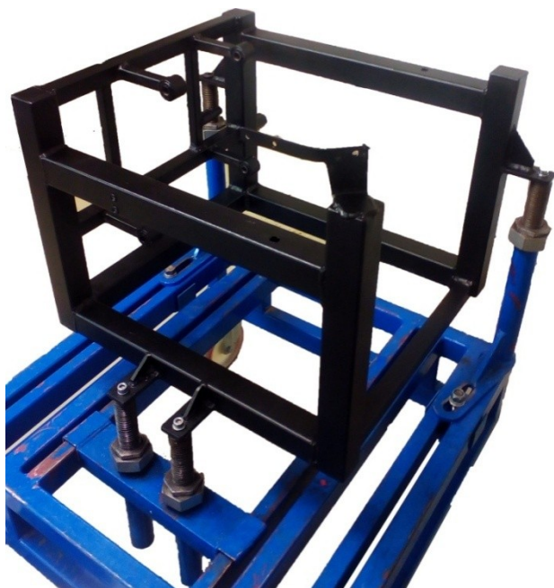
Obr. 62 Rám pro spalovací motor Kawasaki.
