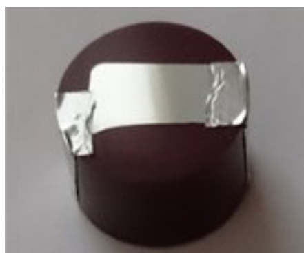
Obr. 18 Vzorek B připravený pro analýzu SEM
