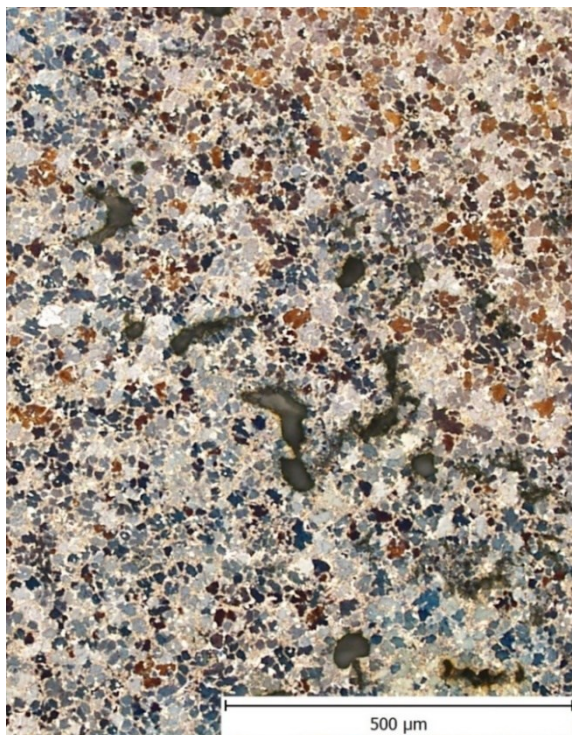
Obr. 21 Mikrostruktura vzorku A v naleptaném stavu: střed.
