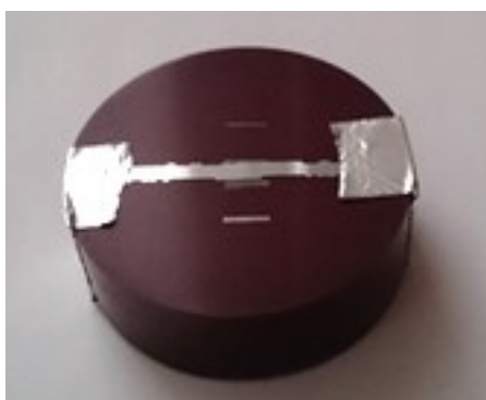
Obr. 17 Vzorek A připravený pro analýzu SEM
