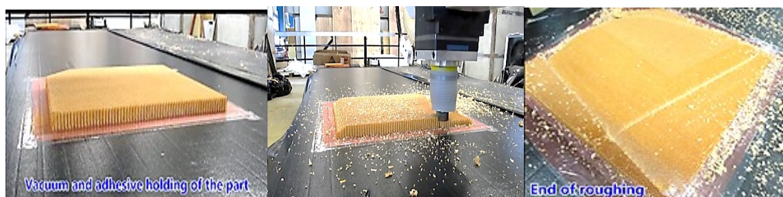
Obr. 18 Postup při prvotním hrubování profilu [12]
