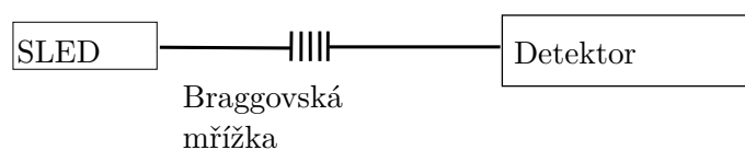
Obrázek 16: Schéma zapojení pro měření odrazného spektra
