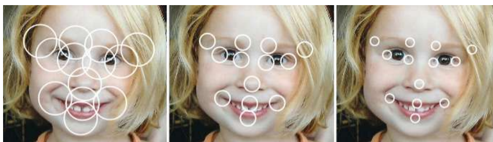
Obrázek 8: Velikosti lokálních oblastí daných zájmových bodů při odlišných stupních kaskády u přístupu založeném na LBF [5].
