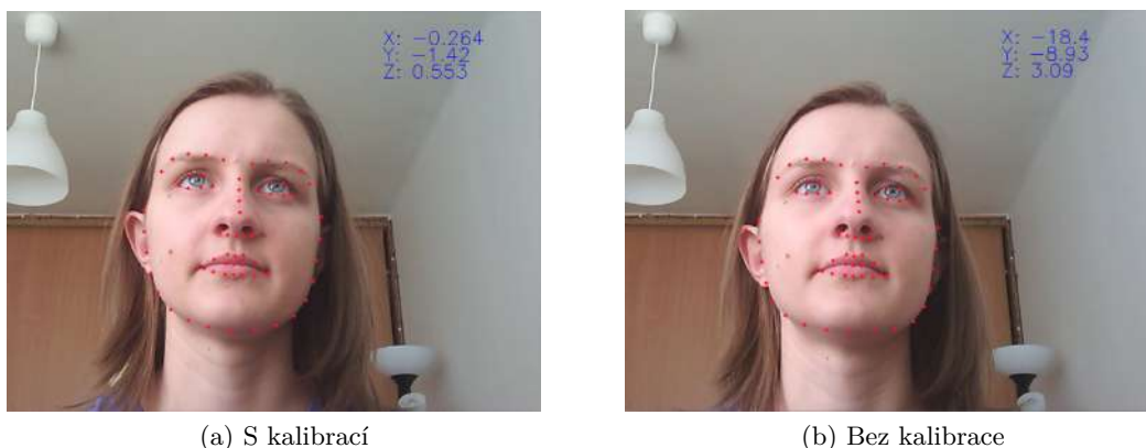
Obrázek 23: Ukázka rozdílu v úhlech rotace při použití kalibrace a bez ní u přibližně stejného natočení hlavy. Na obrázku 23a, kde jsou úhly počítány s prvotní kalibrací se hodnoty pohybují kolem nuly, jelikož byla tato pozice určena jako výchozí. Naopak na obrázku 23b, kde při výpočtech úhlů nebyla brána v úvahu výchozí pozice, jsou hodnoty od nuly více vzdálené.
