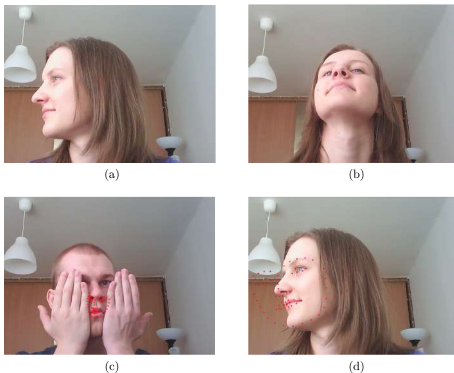
Obrázek 25: Ukázky nepovedené detekce obličeje a zájmových bodů. Na obrázcích 25a a 25b nejsou vyobrazeny zájmové body, jelikož na takových snímcích nebyl detekován žádný obličej. Obrázky 25c a 25d ukazují chybný odhad pozic zájmových bodů.
