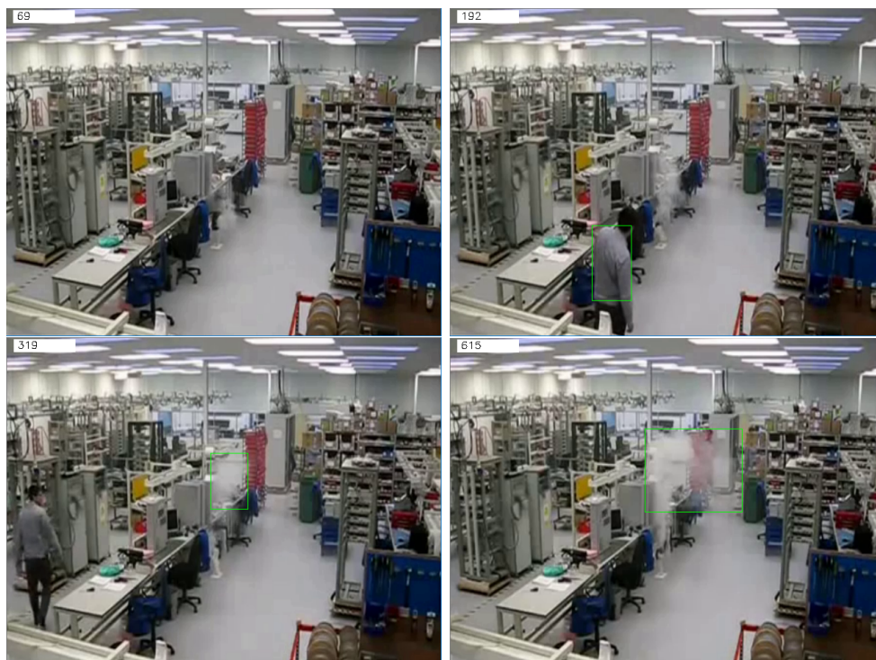
Obrázek 20: Testování videa - simulovaný kouř v laboratoři
