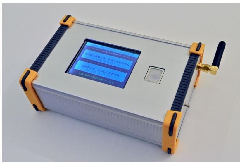
Obr. 40: Hotové funkční řešení vestavěného zařízení pro biometrickou identifikaci pacientů. Na přední straně LCD dotykový displej se senzorem otisků, na boční straně Wi-Fi anténa.
