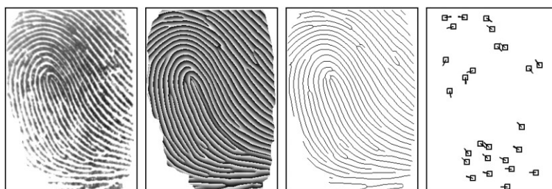
Obr. 9: Technologické kroky při zpracování obrazového signálu Zprava nativní snímek, binarizace, skeletizace, nalezení markantů
