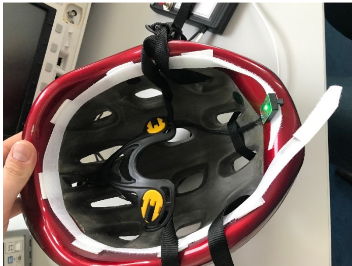
Obrázek 54: Umístění sondy v cyklistické helmě pro měření pulsní křivky na hlavě respondenta při jízdě na kole.
