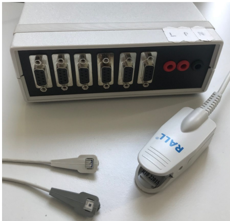
Obrázek 65: Sondy s IR diodou, vlevo sonda pro měření na hlavě, vpravo pro měření na prstu horní končetiny, a zařízení pro multikanálovou pletysmografii.
