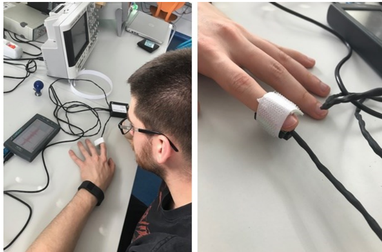
Obrázek 48: Měření pulsní křivky na prstu respondenta.
