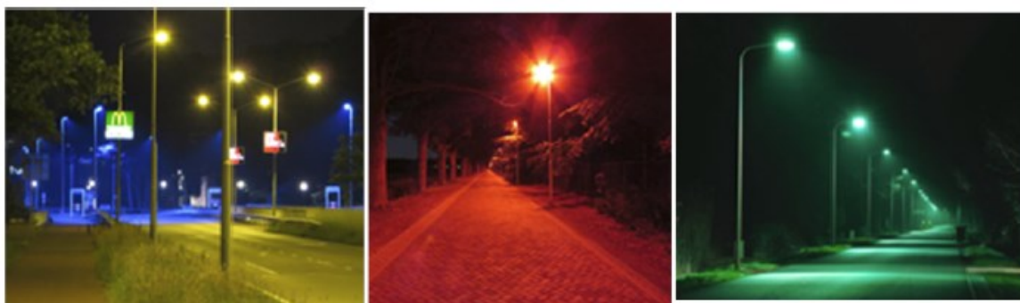
Obr. 1 Ukázka osvětlovacích soustav VO s LED svítidly s odlišnými barvami emitovaného světla (modrá, červená, tyrkysová) [2]
