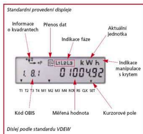
Obrázek 22. Display čtyřkvadrantní elektroměr
