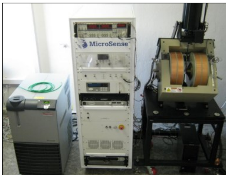
Obrázek 21: Vibrační magnetometr EV9 VSM firmy MicroSense
