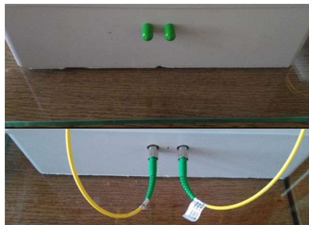
Obrázek 7.2: Fotografie jednoho z testovaných typů rozhraní senzoru ukončené po 30cm optickými SC konektory.
