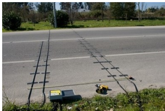
Obrázek 4.2: Princip implementace pneumatického detektoru v praxi, převzato z [28].
