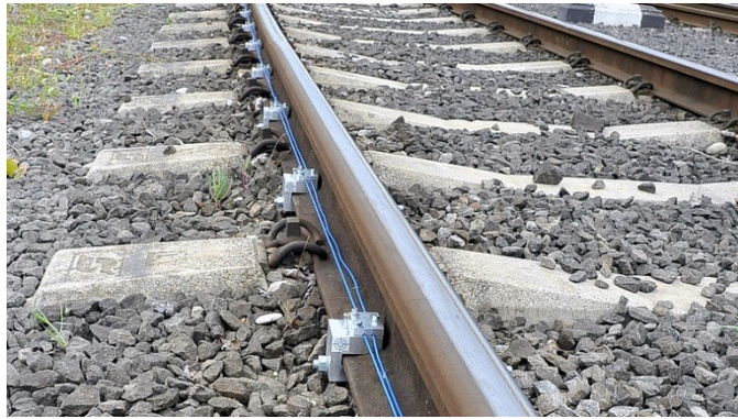
Obrázek 4.16: Implementace optického vlákna na kolejnici, převzato z [89].
