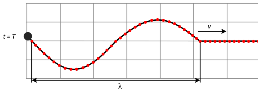
Obrázek 2.6: Grafické znázornění vzniku postupného vlnění.
