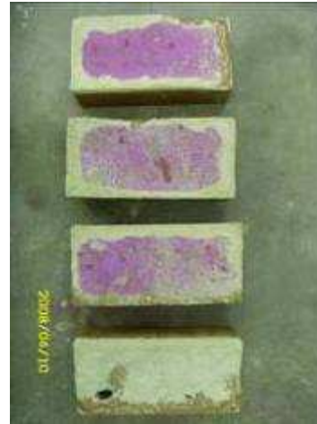
(d) Kielder Orange (Throckley) 24-h total water absorption: 6.4% IRA: 1.3 kg/m 2 /min
