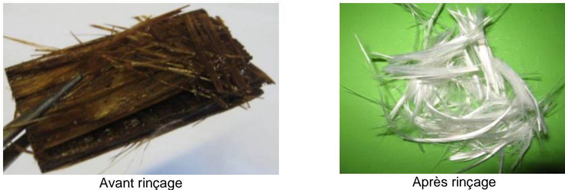
Figure 3 : Fibres après essai 1-1-9
