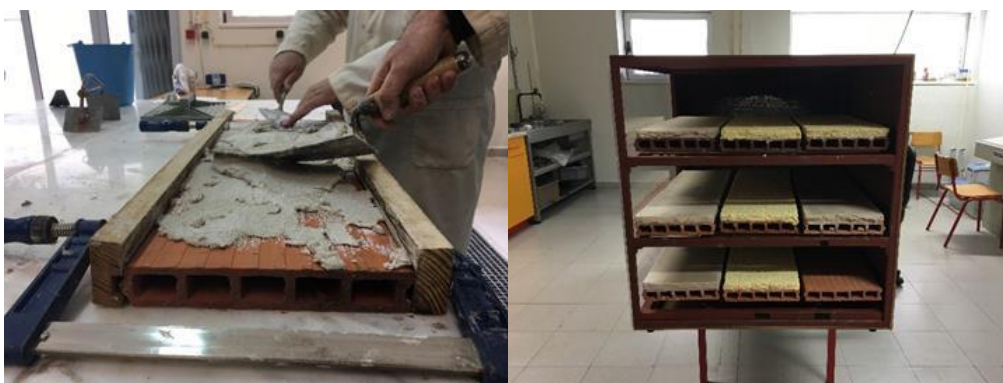
Figura 2. Lado esquerdo – aplicação da argamassa, Lado direito – Colocação dos provetes no túnel de vento.
