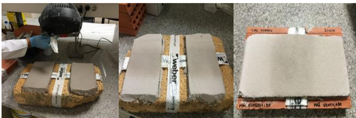
Figura 1a. Passos consecutivos a realizar durante a preparação dos provetes e execução do ensaio de resistência à fissuração em fase plástica.
