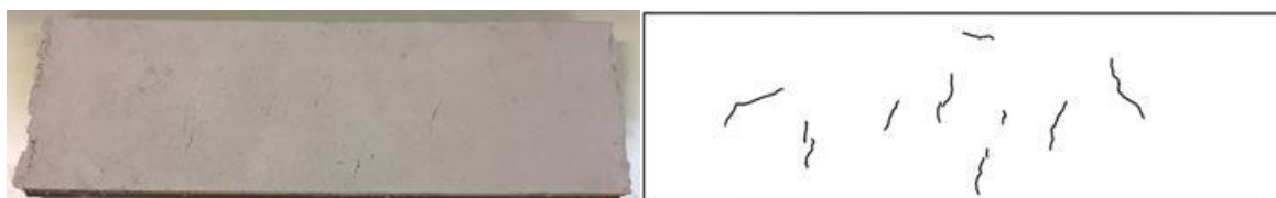
Figura 3. Lado esquerdo – fotografia de um provete, Lado direito – identificação das fissuras.
