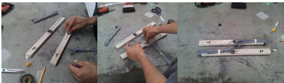
Figura 149. Proceso de instalación de medidor de deformación unitaria en probeta de flexión de fibrocemento.
