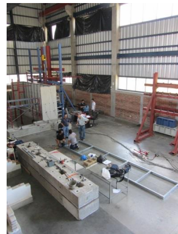
Figura 164. Construcción de la retícula de la estructura del techo.
