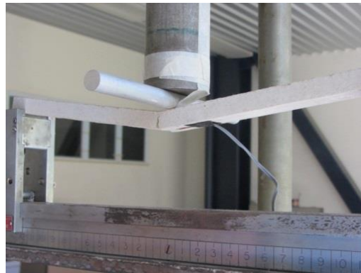
Figura 148. Falla a flexión de probeta de fibrocemento.
