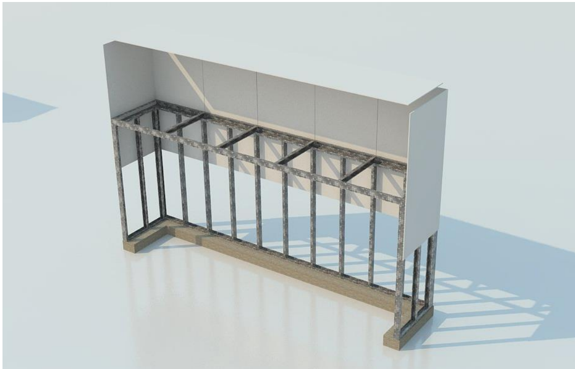
a. Vista en 3d del acoplamiento de las láminas a los perfiles.
