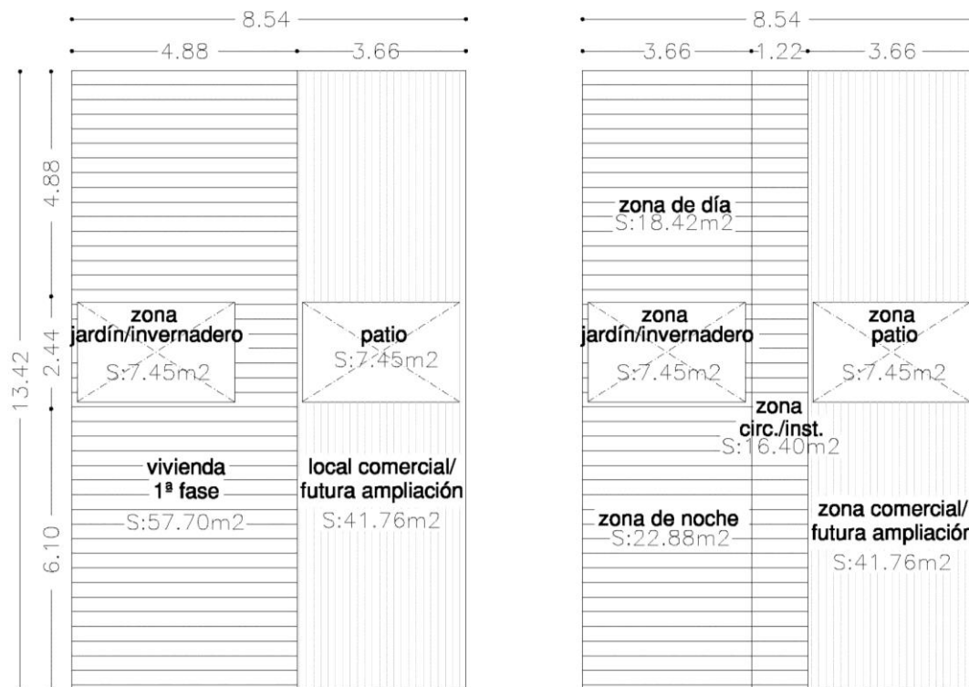
Figura 95. Esquema de zonificación. 1ª Fase de vivienda de emergencia.
