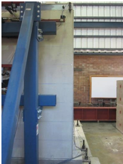
Figura 189. Separación del perfil y lámina en la intersección de las paredes 1 y 3.
