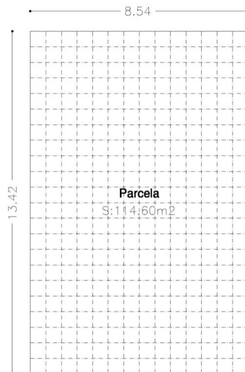
Figura 94. Modulación de la parcela. Malla de 0,61 x 0,61 m.
