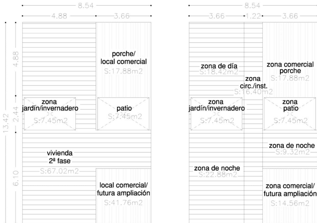
Figura 98. Esquema de zonificación. 2ª Fase de vivienda de emergencia.
