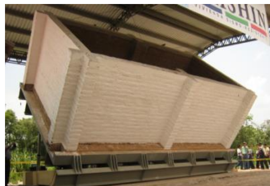
Figura 128. Ensayo en mesa inclinable, UES, [1].
