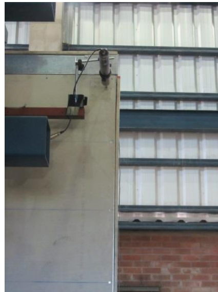
Figura 189. Separación del perfil y lámina en la intersección de las paredes 1 y 3.
