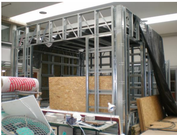
a. Laboratorio de ensayos de la Universidad de Coimbra. Prototipo de acero liviano.
