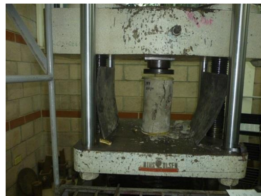
Figura 153. Rotura probeta de hormigón.
