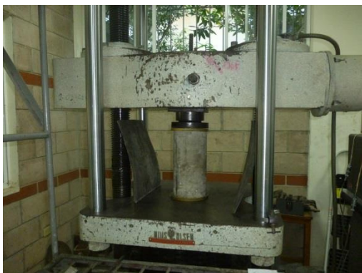
Figura 152. Inicio del ensayo del hormigón.
