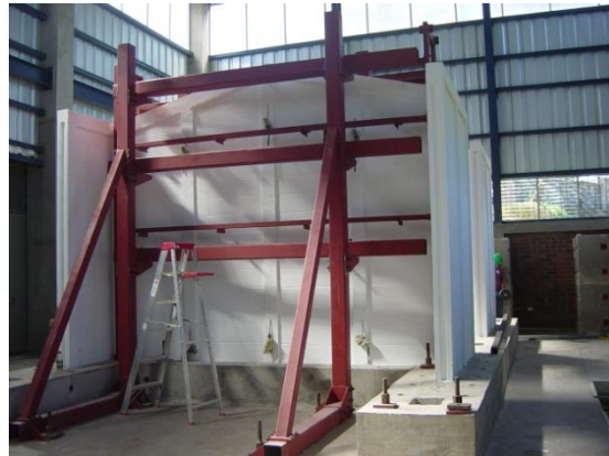
Figura 126. Ensayo en Laboratorio Estructuras Grandes, UCA. Sist. Bloque Panel. Taishim [1].
