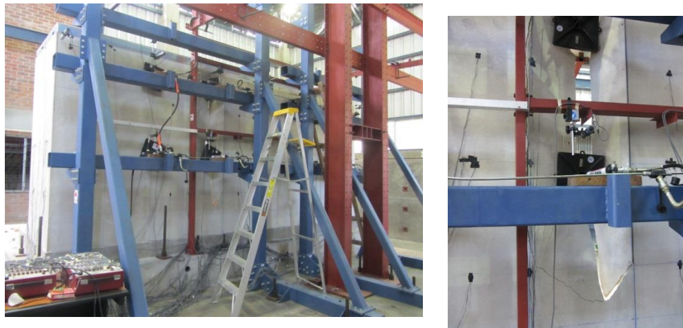
Figura 195. Colapso de la fisura G4 en la cara oeste de la pared 1.
