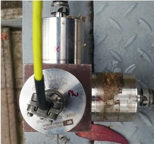
Figura 11: Configuración espacial de los sensores vista desde arriba.
