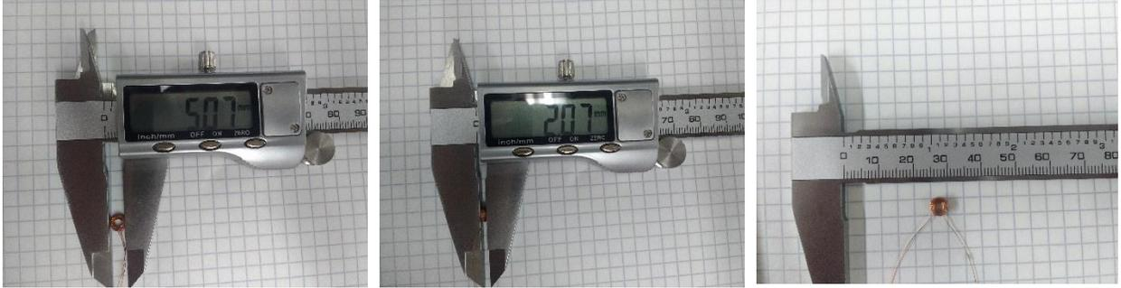
Figura 12. Vista superior lateral y escala real de la bobina construida.
