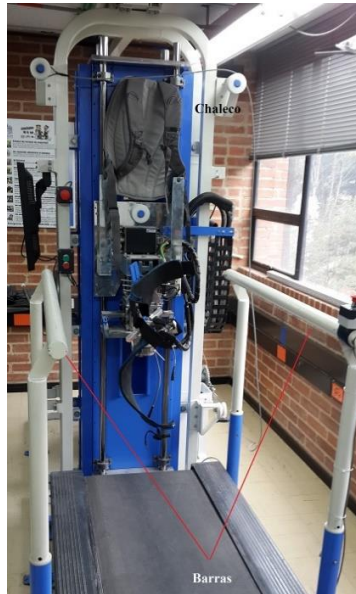
Figura 25: Equipo de seguridad de la maquina IBWS.
