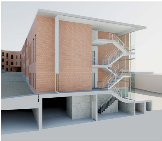
Imagem 18 - Cortes perspetivados do átrio de entrada dos blocos habitacionais.
