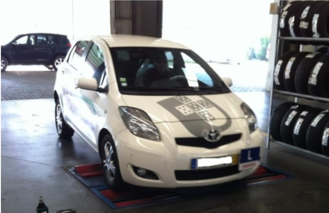
Figura 15 - Automóvel a ser testado na máquina de inspeção
