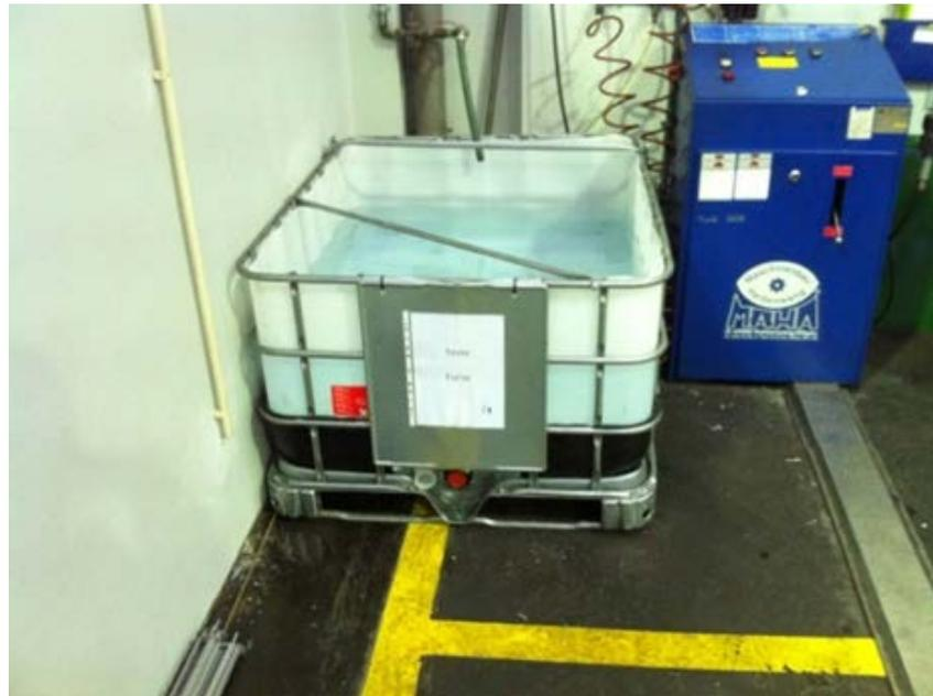
Figura 24 - Tanque para verificação de furos em pneus
