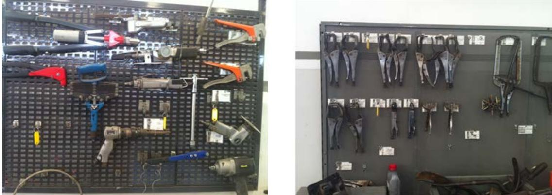
Figura 33 - Painéis com Identificação da Falta de Ferramenta
