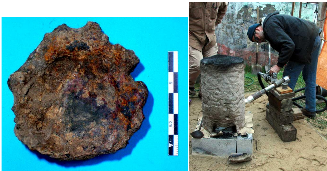
Figuur 35. Foto van de ijzerslak met indruk van een mal (of oven ?) en een foto van een experimentele oven in klei/leem (bron: http://www.warehamforge.ca/ironsmelting/Brown-11/air-system.jpg ).
