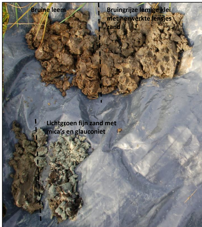
Afb. 16: Boorstaal van boorpunt 18 die de natuurlijke ondergrond toont.
