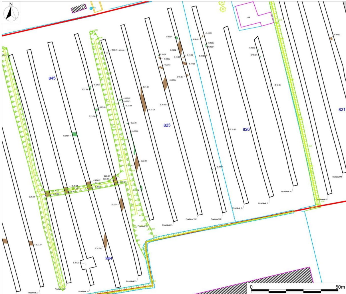
Figuur 31: Sleuven in centrale zone
