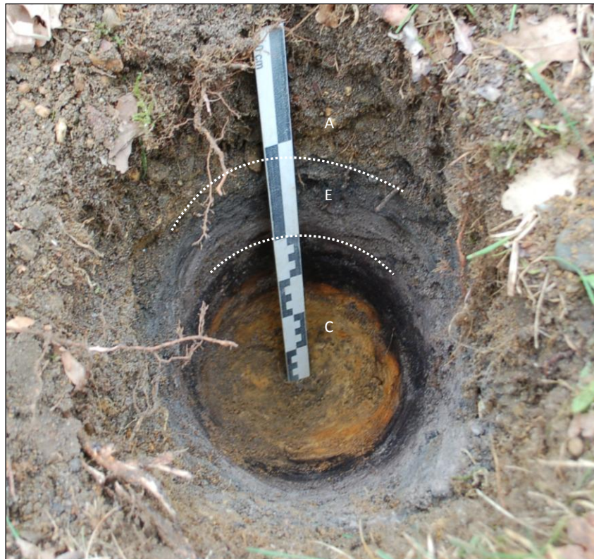
Afb. 10. Boorprofiel van boorpunt 138, waarin onder de bouwvoor de E-, B- en C-horizont zichtbaar zijn.
