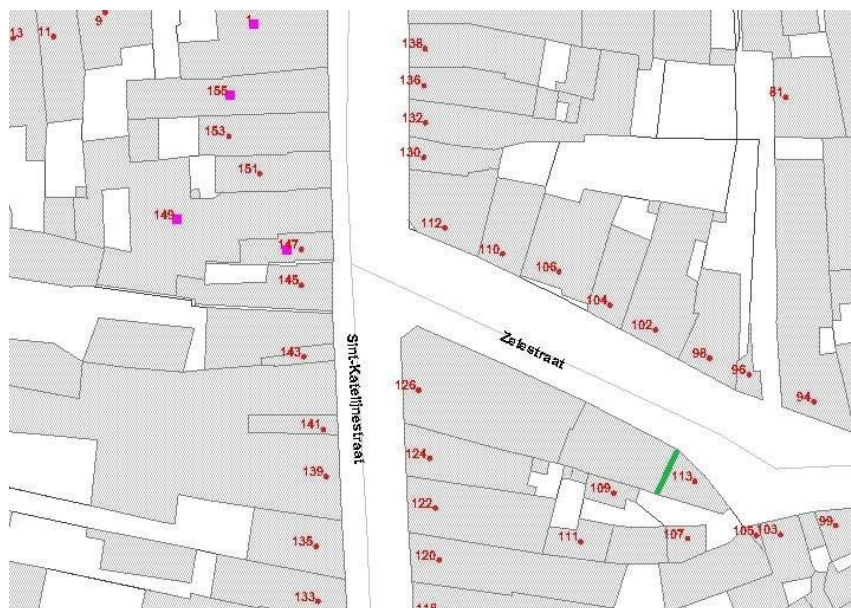
Fig. 8 met aanduiding van de scheidingsmuur tussen het bijgebouw van Sint-Katelijnestraat 126 en Zelestraat 113 (deel van beluik) in het groen
