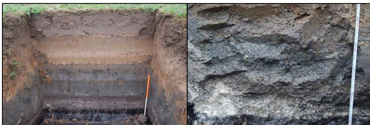
Afb. 9-10: Proefput 2 met onderaan het veen en daarboven de afzetting van moeraskalk, bedekt door alluviale pakketten met kleiaanrijking. Rechts een detail van de laag moeraskalk.
