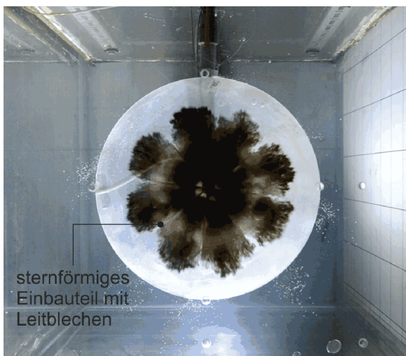
Abbildung 100: Ausströmen aus BES_1 mit Leitblechen bei Zugabe von Tinte in den Belader, \dot{V}_{\text{ein}} = 2 \text{ m}^3/\text{h} , \Delta T = 20 \text{ K}
