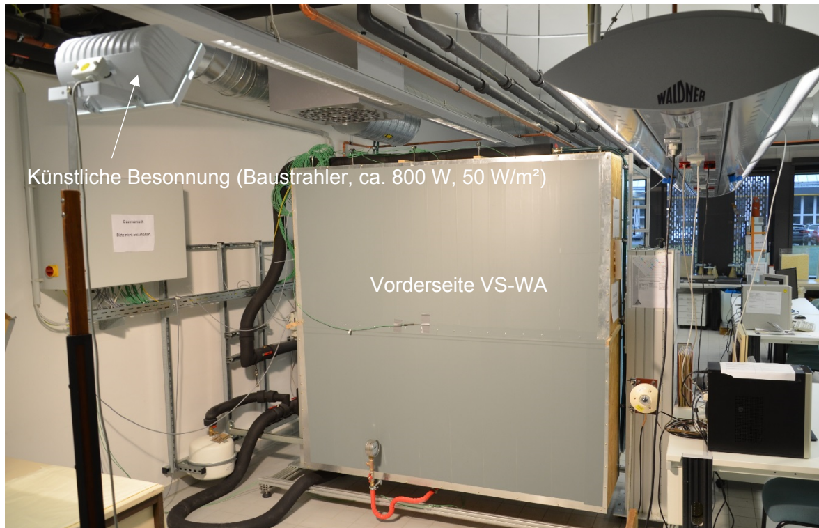
Abbildung 53: Versuchsaufbau für künstliche Besonnung am VS-WA
