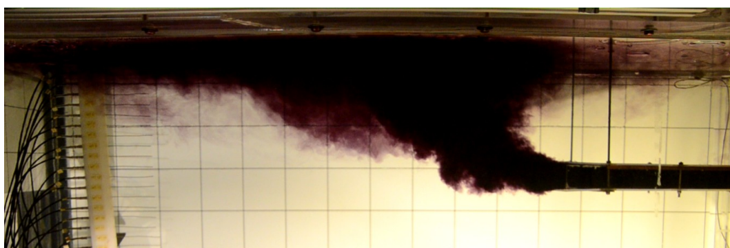
Abbildung 94: Schichtungsaufbau bei einem Deckenabstand von 200 mm ( \Delta T = 20 \text{ K} , \dot{V} = 2 \text{ m}^3/\text{h} )
