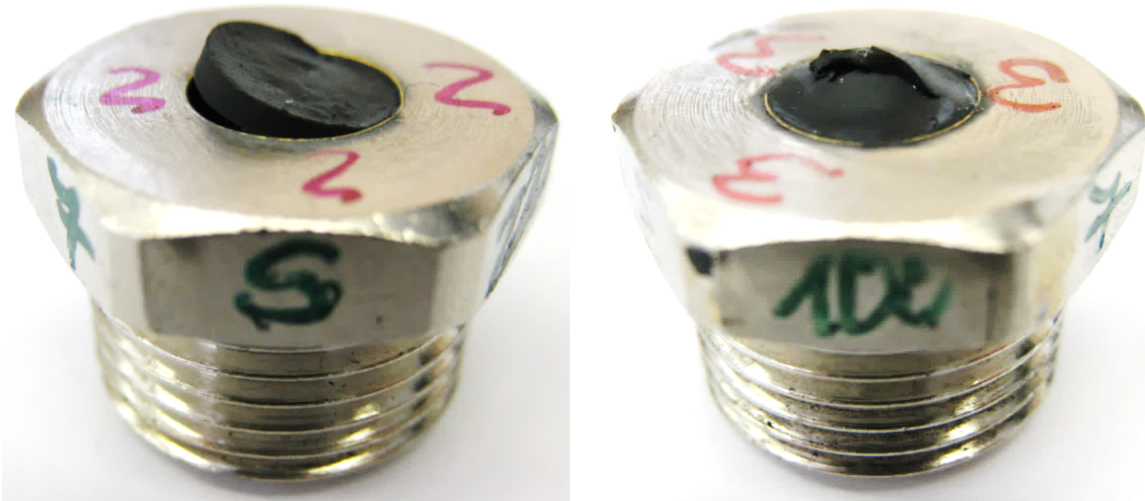
Abbildung 19: Bruchbilder von Dichtstoffproben; links: adhäsives Versagen; rechts: kohäsives Versagen
