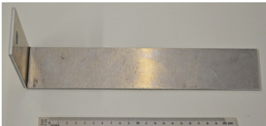
Abbildung 172: Abstandshalter im Wandaufbau; Standardausführung mit Aluminium
