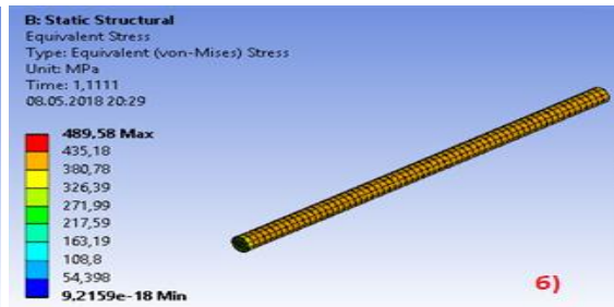
Рисунок 3 Розподіл деформацій – а) та напружень – б) після прикладання сили 817 Н
