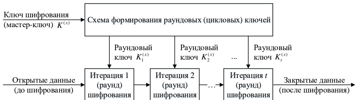
Рис. 1. Структурная схема итеративного блочного шифра
