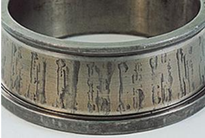
10.7. ábra: A csapágyhiba 6. stádiumában tipikus kopásképe
