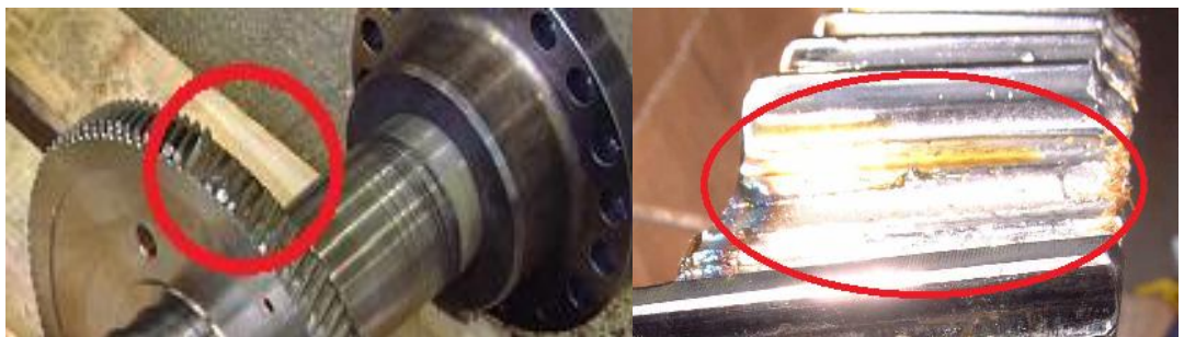
2.37. ábra: Fogaskerék tönkremenetele kifáradás miatt [1]
