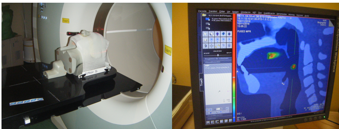
Figura 3.4: Configuración experimental para el estudio del co-registro de la imagen PET/CT y de la interpolación de esta al grid de cálculo de dosis. A la izquierda, maniquí utilizado para el estudio, sobre el sistema de inmovilización para pacientes de cabeza y cuello. A la derecha, imagen del software Syngo.via utilizado para generar las diferentes reconstrucciones de la imagen PET/CT.
