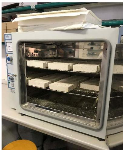
Fig. 22 Secado de las probetas tipo A en estufa. (EP)
