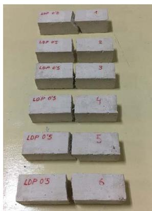
Fig. 31 Disparidad entre probetas 0,5% PEBD sometidas a ensayo de compresión. (EP)
