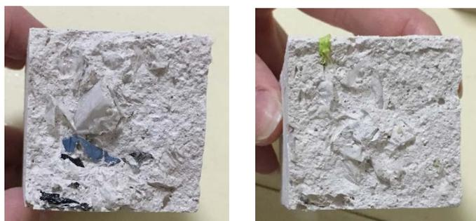
Fig. 26 Disposición partículas PEBD en probetas con 1% adición. (EP)
