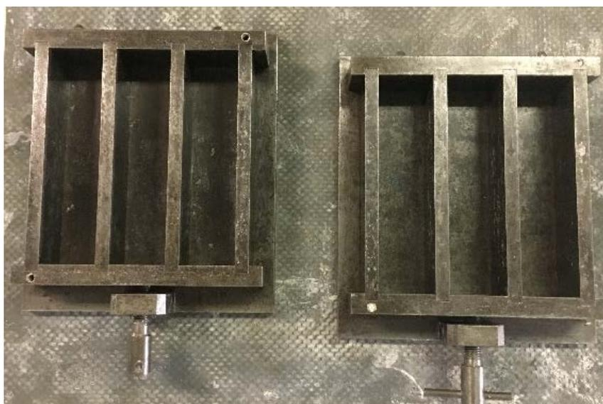
*Fig. 15 Moldes probetas ensayos mecánicos. (EP)*
