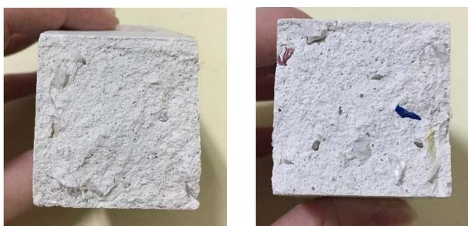
Fig. 25 Disposición partículas PEBD en probetas con 0,5% adición. (EP)
