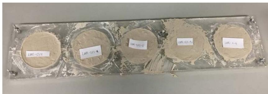
Fig. 19 Vertido de la mezcla en moldes para ensayo acústico. (EP)
