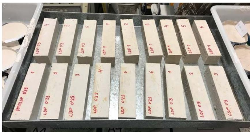
Fig. 7 Probetas tipo A para ensayos mecánicos. (EP)
