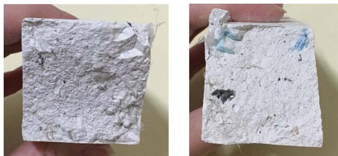
Fig. 30 Mitad A (izquierda.) y mitad B (derecha) de una probeta con 0,25% PEBD para mostrar distribución heterogénea partículas de plástico. (EP)
