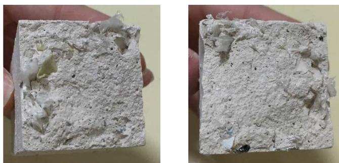
Fig. 34 Mitad A (izquierda.) y mitad B (derecha) de una probeta con 1% PEBD para mostrar distribución heterogénea partículas de plástico. (EP)
