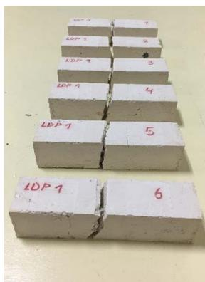
Fig. 33 Disparidad entre probetas 0,5% PEBD sometidas a ensayo de compresión. (EP)
