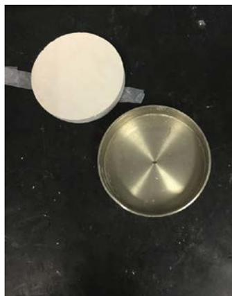
Fig. 36 Colocación de probeta tipo C en porta-muestras. (EP)
