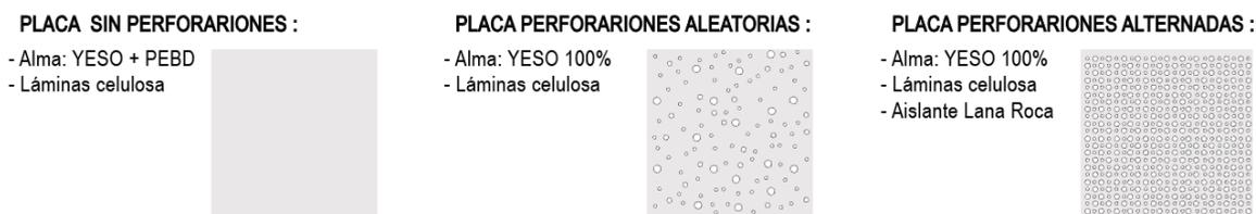
Fig. 45 Placas yeso laminado para falso techo seleccionados para comparativa. (EP)
