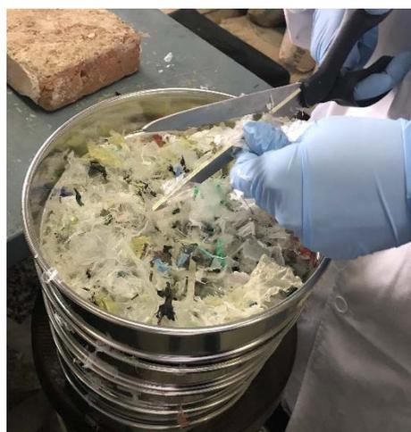
Fig. 12 Preparación del material plástico de adición: Triturado bolsas PEBD. (EP)
