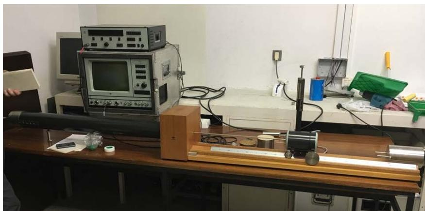
Fig. 35 "Tubo de Kund" para ensayo de absorción acústica. (EP)
