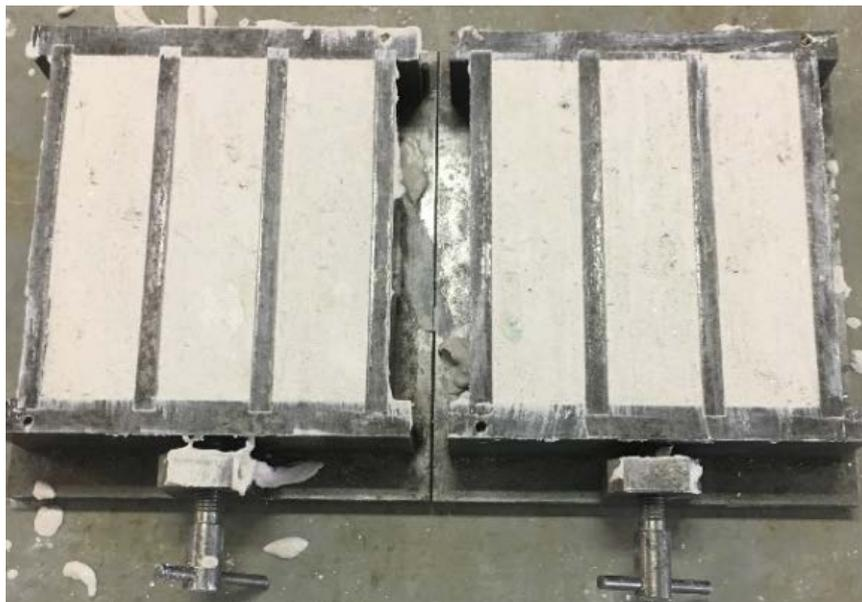
Fig. 16 Vertido de la mezcla en moldes para ensayos mecánicos. (EP)
