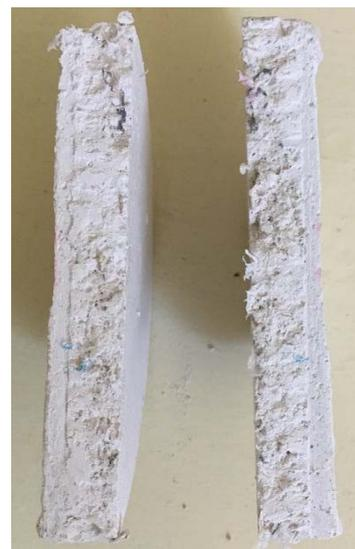
Fig. 40 Muestra ensayo acústico 1% LDPE rota. (EP)
