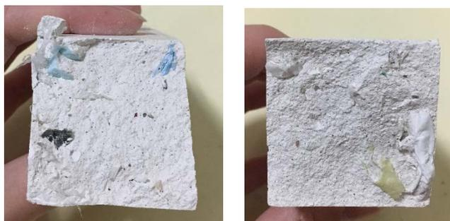
Fig. 24 Disposición partículas PEBD en probetas con 0,25% adición. (EP)
