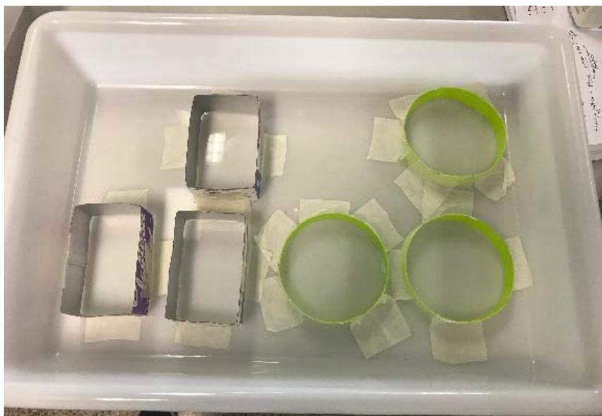
Fig. 17 Moldes ensayos térmico (izquierda) y acústico (derecha). (EP)
