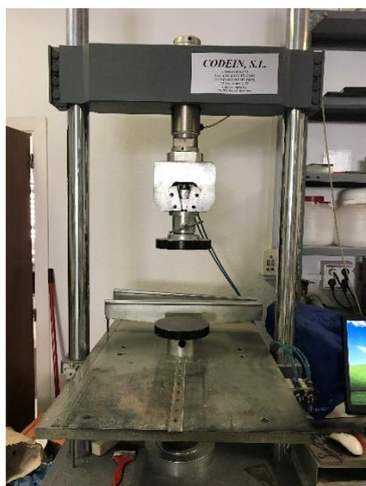
Fig. 20 Prensa multiensayo para realizar los ensayos de flexión y compresión. (EP)
