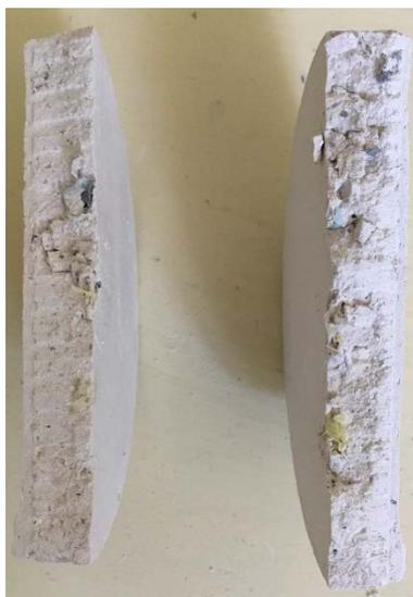
Fig. 39 Muestra ensayo acústico 0,5% LDPE rota. (EP)
