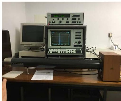
Fig. 37 Disp. analizador de máx. y mín. onda estacionaria. (EP)
