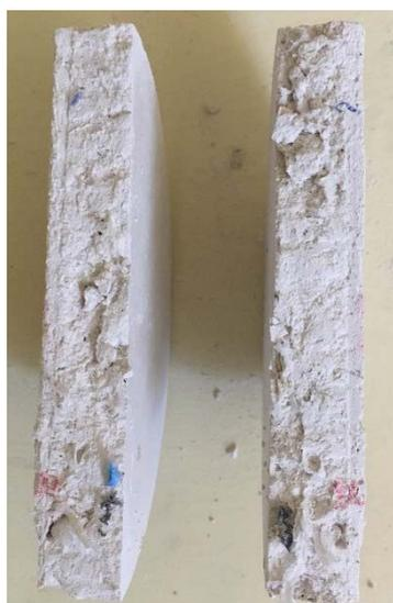
Fig. 38 Muestra ensayo acústico 0,25% LDPE rota. (EP)
