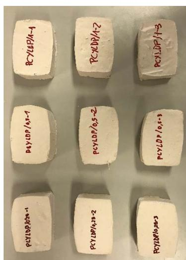
Fig. 8 Probetas tipo B para ensayo térmico. (EP)
