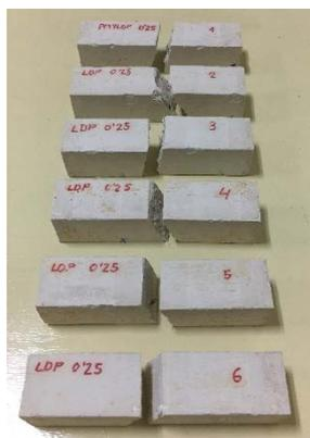
Fig. 29 Disparidad entre probetas 0,25% PEBD sometidas a ensayo de compresión. (EP)
