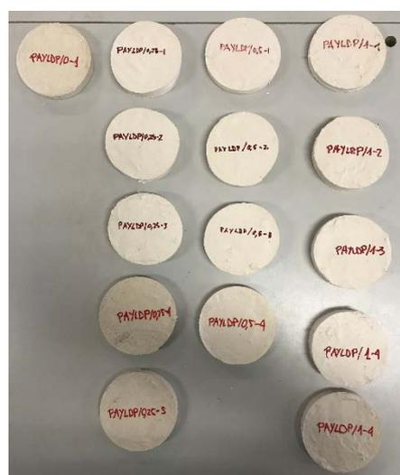
Fig. 9 Probetas tipo C para ensayo acústico. (EP)
