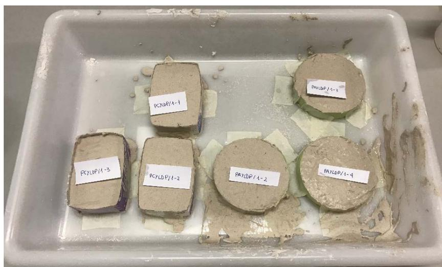
Fig. 18 Vertido de la mezcla en moldes para ensayo térmico. (EP)
