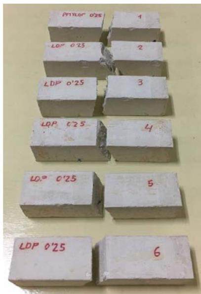
Fig. 27 Probetas resultantes ensayo flexión, que se utilizarán en ensayo compresión. (EP)
