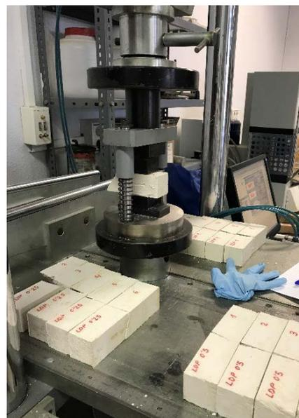
Fig. 28 Rotura de la probeta a compresión. (EP)
