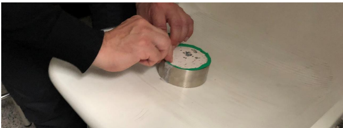
Figura 8: Muestra sobre el soporte del tubo de Kunt con plastilina para asegurar que queda bien encajada. Foto tomada en el laboratorio
