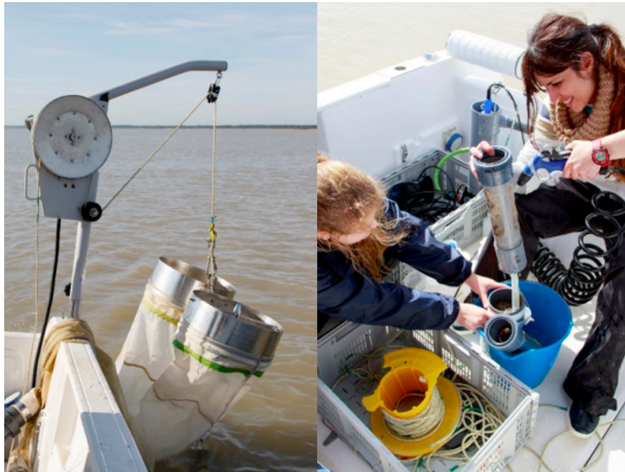
Figura 6. Recogida de la muestra de copépodos en el río Guadalquivir usando la red Bongo.
