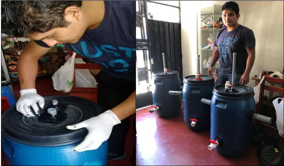
Ilustración 13. Construcción de los tres biodigestores de tipo semicontinuo.
