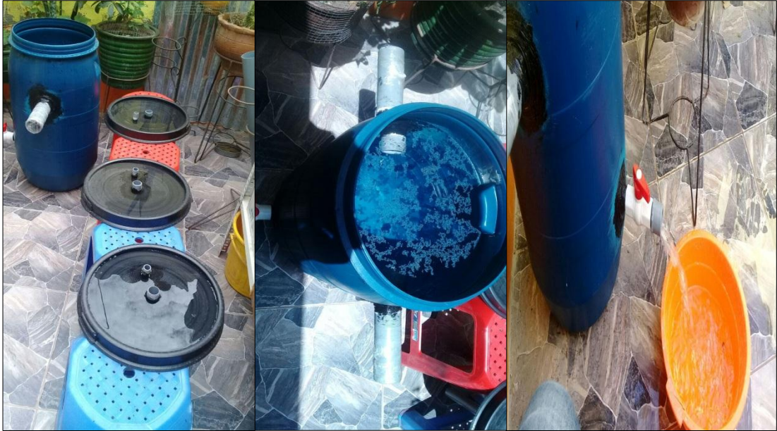
Ilustración 15. Prueba de permeabilidad de los biodigestores de tipo semicontinuo.
