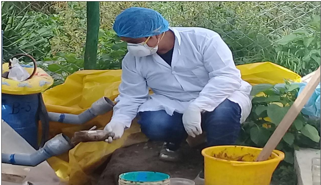
Ilustración 20. Alimentación de los biodigestores de tipo semi continuo al 8 % y 9%; en función de los 30 y 60 días.
