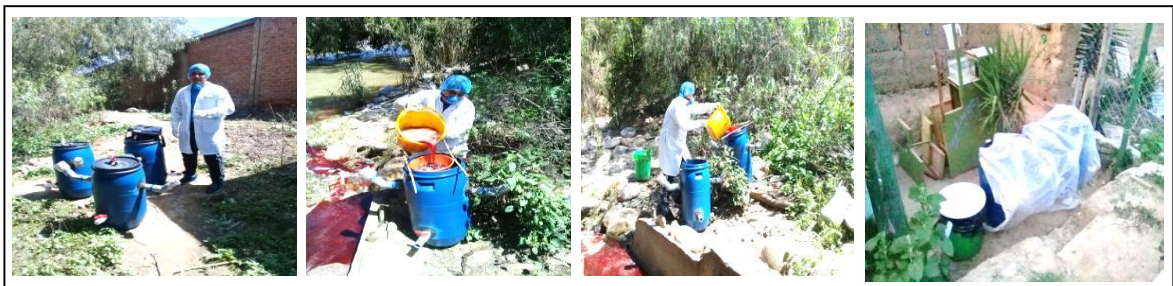
Ilustración 3. Almacenamiento de la muestra de las aguas residuales del Camal Municipal de Huánuco.
