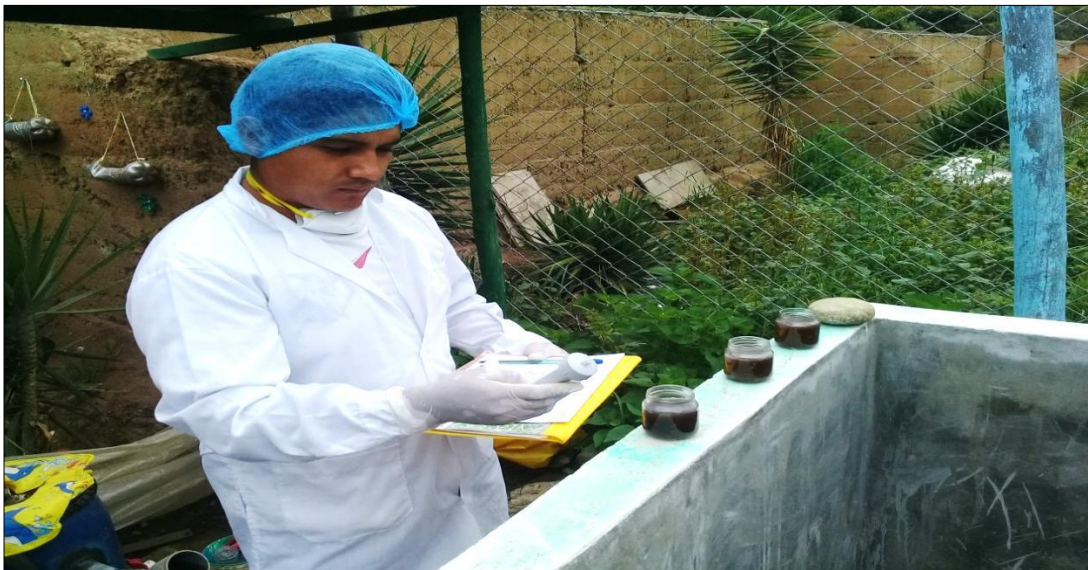
Ilustración 18. Registro y monitoreo diario de los parámetros físicos y químicos del biol, utilizando el multiparámetro, termómetro ambiental, conductímetro, recipientes de vidrio y equipos de protección personal.
