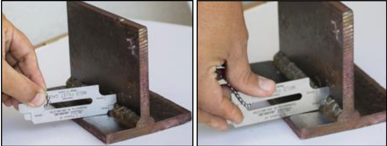
Figura 14.2. Uso de galgas para medir el tamaño de la soldadura en filete (2)
