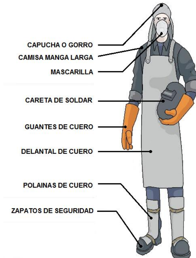
Figura 10.1. Esquema del sistema de protección personal para un soldador (90)
