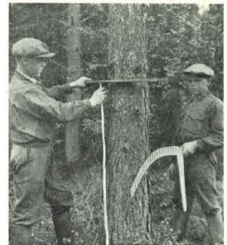
Rinnankorkeusläpimitan mittausta käyräasteikkoisella kulmakaulaimella. (Y. I—o.)
