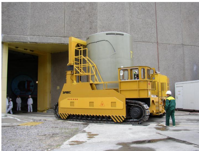
Рис. 1 – Транспортировка СХОЯТ-а от блока АЭС к площадке хранения
