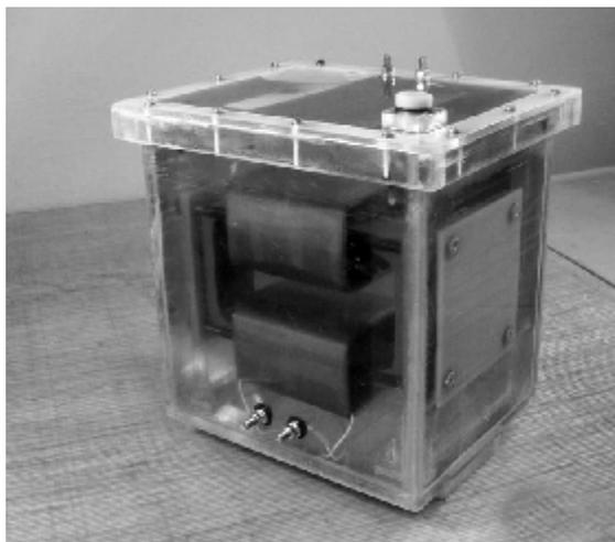
Общий вид высокопотенциального трансформатора напряжением 100 кВ с масляной изоляцией
