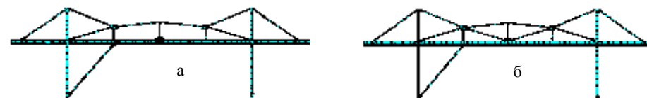
Рис. 9. Различия шпренгельных систем: а – прототип; б – исследуемая модель
