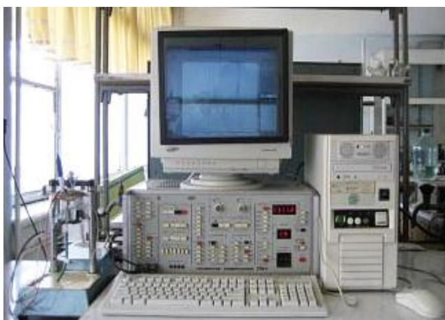
Рис. 6.3. Современная полярографическая установка Гейровского.
