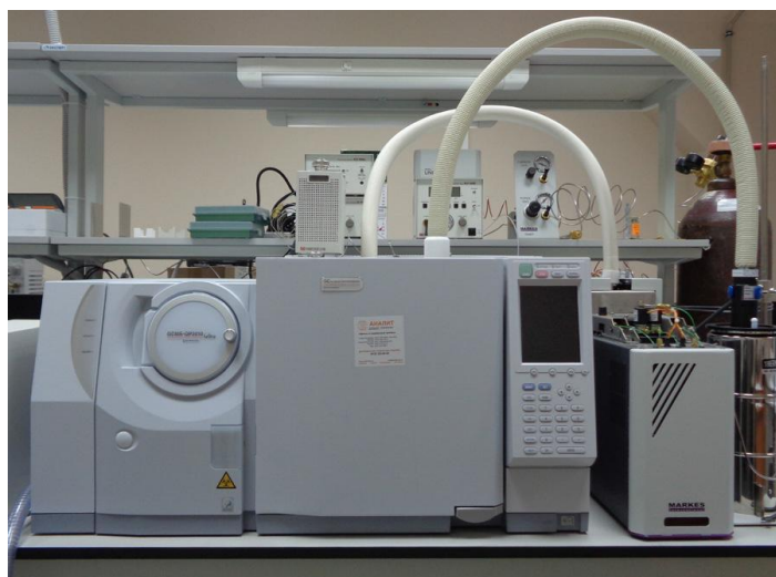
Рис.6.2. Газовый хромато-масс-спектрометр – современный прибор для анализа проб экологического мониторинга.
