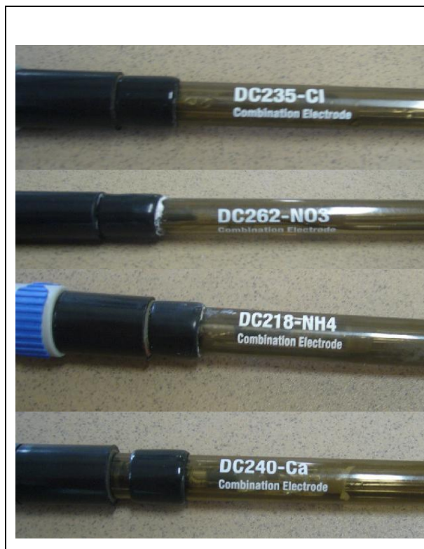
Рис. 6.6. Ионоселективные электроды для определения анионов \text{Cl}^- , \text{NO}_3^- и катионов \text{NH}_4^+ , \text{Ca}^{2+} .
