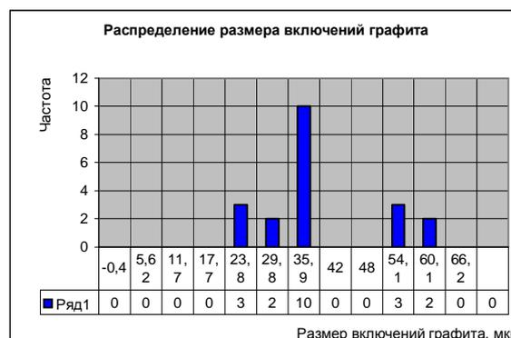
Рисунок 3. Характеристики микроструктуры чугуна, модифицированного ФС75
