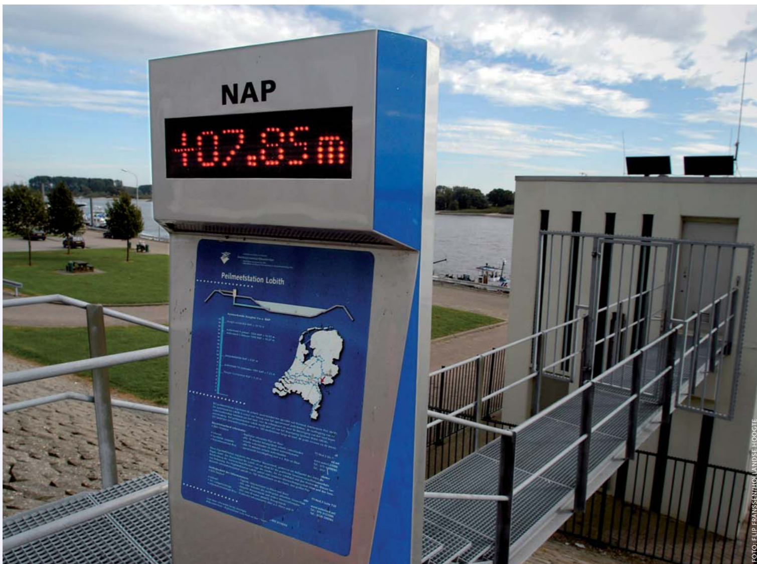
Peilmeetstation bij Lobith, waar de nauwkeurige waterstand van de Rijn wordt gemeten.
