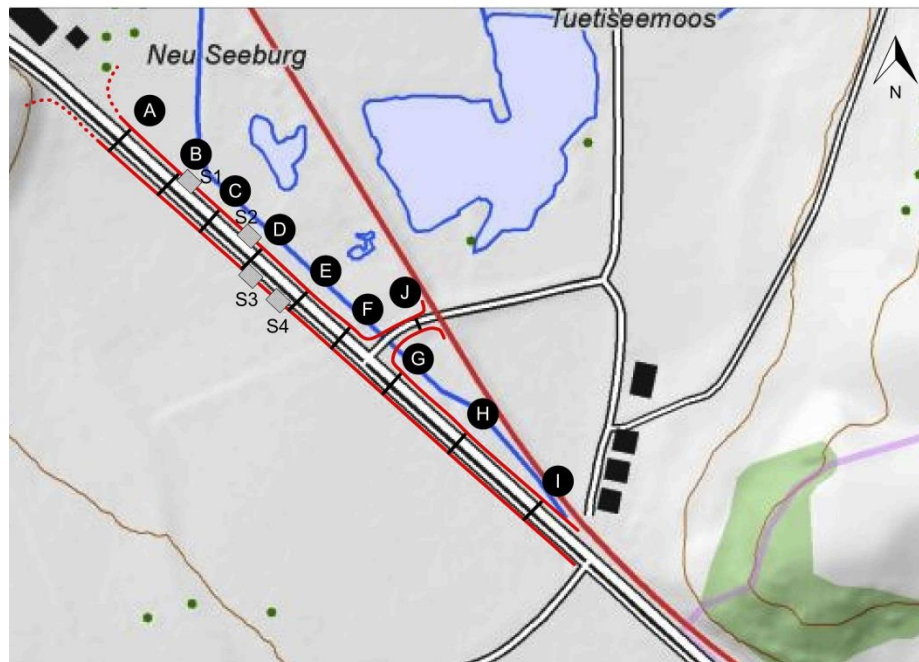
Karte 10: Luftbild und Kartenausschnitt mit Übersicht der Amphibien-Leitanlage und -Tunnel in Menznau. Eingezeichnet ist im Weiteren die Lage des Anwanderzauns für die Zählungen mit den Eimern. Quelle: swisstopo
