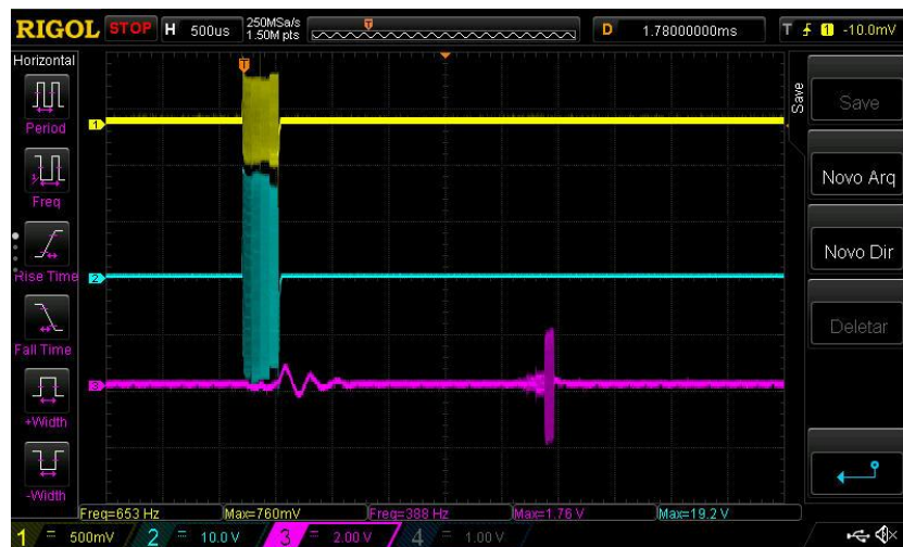
Figura 103 - Envio e recepção dos sinais a 6 metros de distância. Amarelo a tensão de saída do DAC, azul a tensão à saída do amplificador de potência e a roxo o sinal de entrada após filtragem e amplificação
