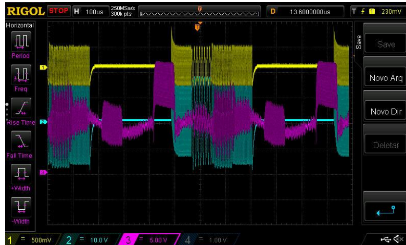
Figura 91 – Envio delay 300 \mu s. Amarelo a tensão de saída do DAC, azul a tensão à saída do amplificador de potência e a roxo o sinal de entrada após filtragem e amplificação.
