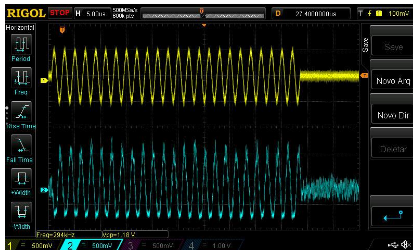
Figura 83 - Entrada do ADC (amarelo) e saída do DAC (azul).
