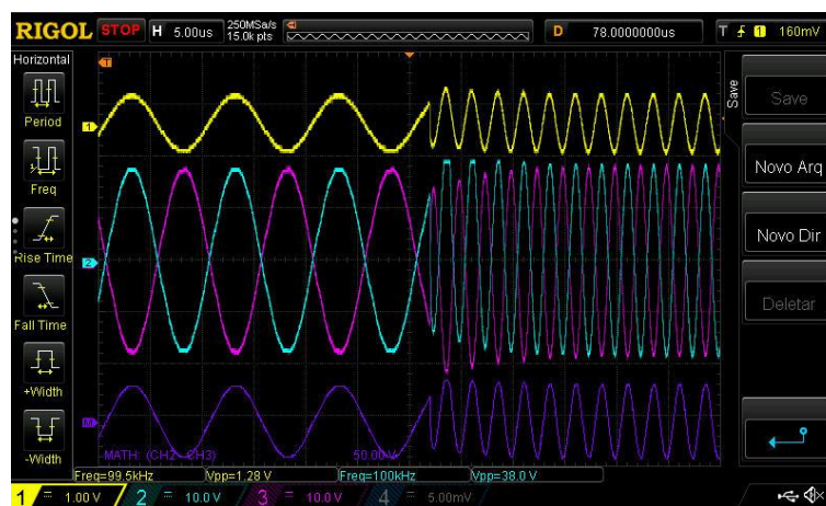
Figura 85 – Sinais da amplificação. Amarelo a tensão de saída do DAC, azul a tensão à saída do amplificador do canal não inversor, a lilás a tensão à saída do amplificador do canal inversor e a roxo o somatório dos dois canais do amplificador de potência.
