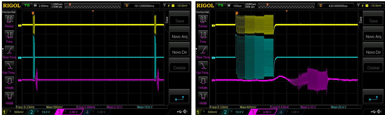
Figura 100- Envio e recepção dos sinais a 1 metro de distância. Amarelo a tensão de saída do DAC, azul a tensão à saída do amplificador de potência e a roxo o sinal de entrada após filtragem e amplificação.
