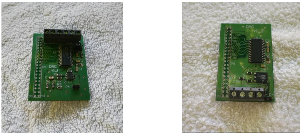
Figura 50 - DACs protótipos. À esquerda a PCB com o AmpOP e à direita a PCB com o Transformador RF.
