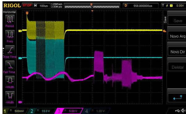
Figura 92 - Envio delay 5ms. Amarelo a tensão de saída do DAC, azul a tensão à saída do amplificador de potência e a roxo o sinal de entrada após filtragem e amplificação.
