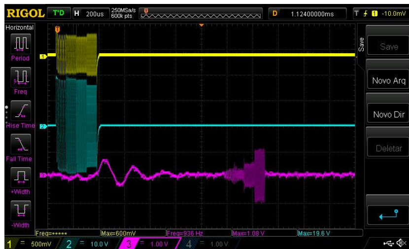
Figura 101 - Envio e recepção dos sinais a 2 metros de distância. Amarelo a tensão de saída do DAC, azul a tensão à saída do amplificador de potência e a roxo o sinal de entrada após filtragem e amplificação
