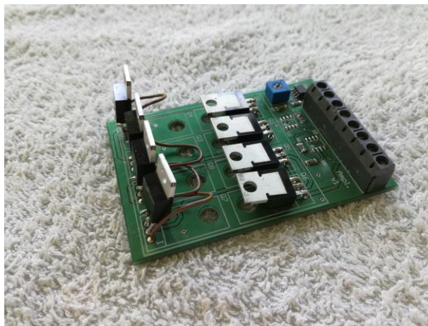
Figura 53 - Protótipo do Amplificador de potência com transistores.
