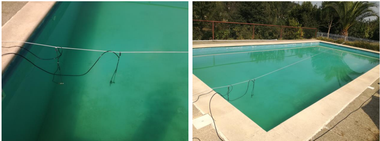
Figura 99 - Distância de 1 metro entre o emissor e o recetor na piscina.
