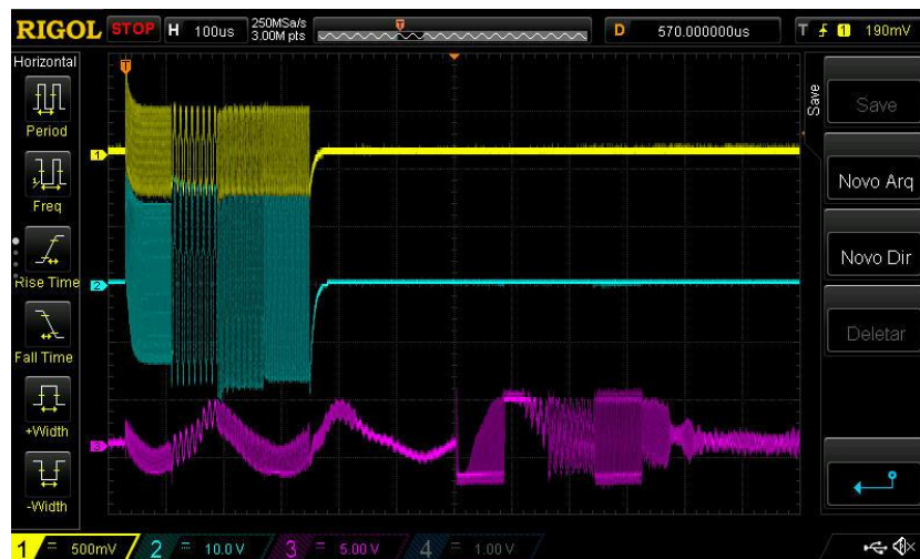
Figura 93 - Envio com filtro. Amarelo a tensão de saída do DAC, azul a tensão à saída do amplificador de potência e a roxo o sinal de entrada após filtragem e amplificação.
