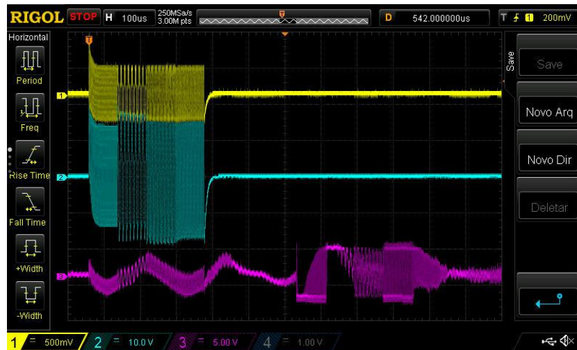
Figura 94 - Envio com baterias. Amarelo a tensão de saída do DAC, azul a tensão à saída do amplificador de potência e a roxo o sinal de entrada após filtragem e amplificação.
