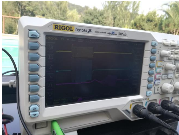
Figura 75 – Osciloscópio DS1054 da Rigol utilizado para retirar as imagens de todos os testes efetuados.
