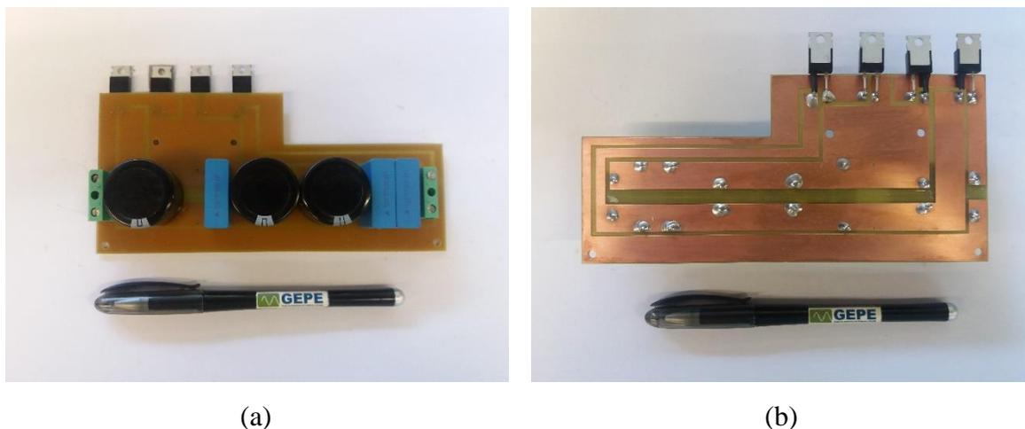
Figura 5.10 - Resultados finais da placa do retificador de alta-frequência desenvolvida: (a) visão da parte superior da placa (TOP); (b) visão da parte inferior da placa (BOTTOM).
