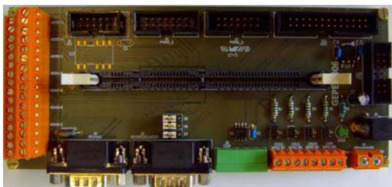
Figura 5.16 - Placa de adaptação de DSP (desenvolvida no GEPE).
