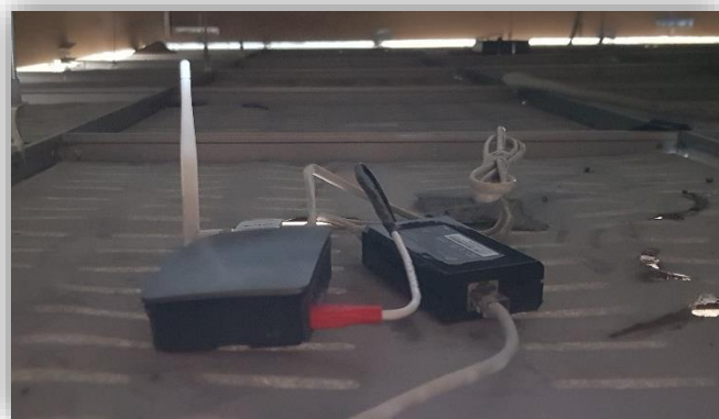
Figura 16 – Despliegue de RP, con segunda interfaz y alimentación a través de PoE
